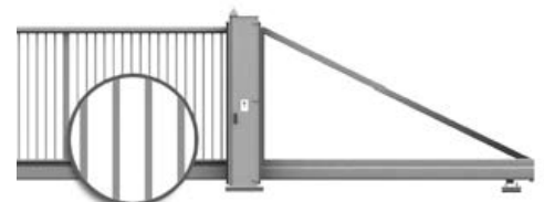
Füllung in Form von geschlossenen Profilen 30 x 18 mm an die Konstruktion geschweißt. Auch als Durchgangsfüllung erhältlich.
